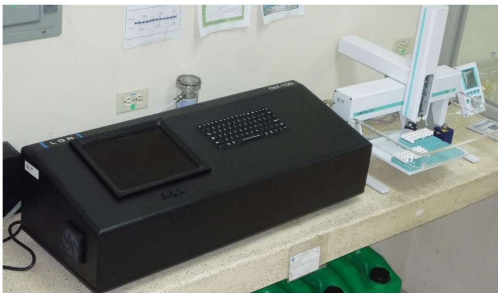
Figura 4. 4 Equipo láser analizador de isótopos y automuestreador
