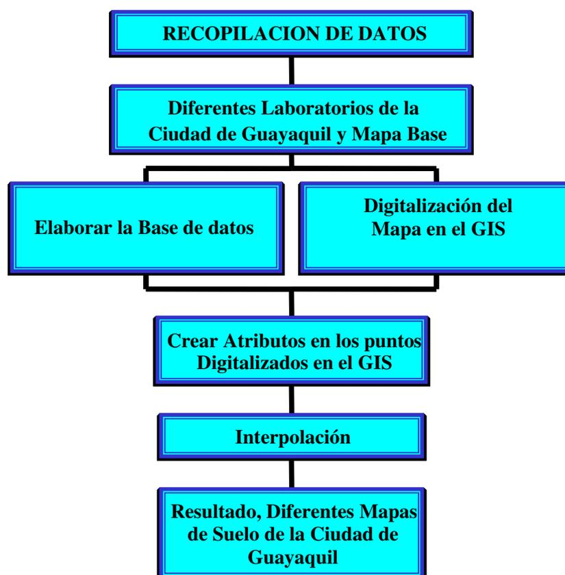
**Figura 3.1.-** Metodología usada en la presente tesis para la elaboración de Mapas geotécnicos. (Criollo, 2002)
