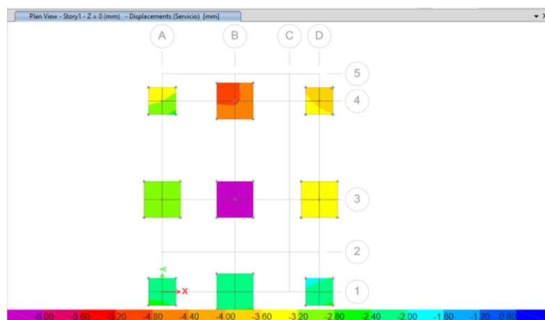
**Ilustración 3.104: Asentamientos en suelo debido a D+L**
