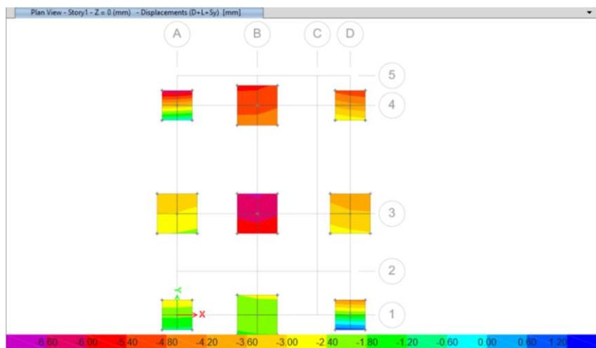
**Ilustración 3.106: Asentamientos en suelo debido a D+L+Sy**
