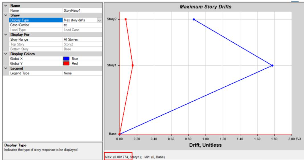
**Ilustración 3.60 Deriva máxima en la dirección X**
