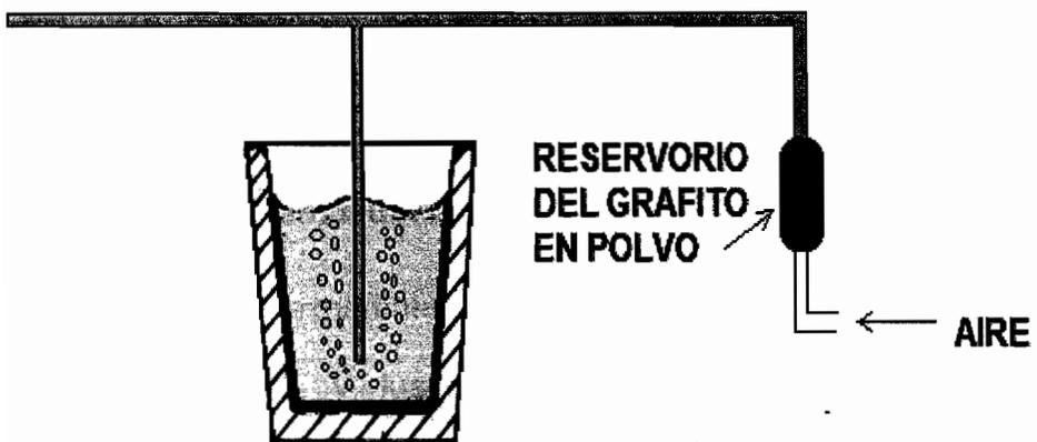
**FIGURA 2.11 EQUIPO ADAPTADO PARA LA RECARBURACION**
