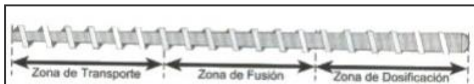
Figura # 7 Esquema de un tornillo simple de extrusión
