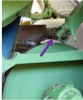
Figura 31: Rascadores/ Máquina Papelera Sitio Web: Industria Papelera
