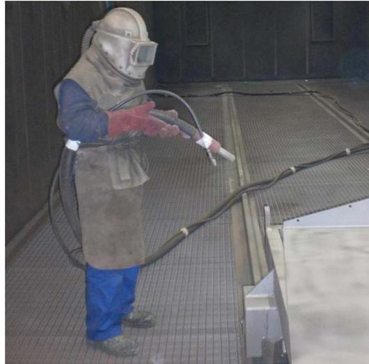
**FIGURA 4.3 - EQUIPO DE PROTECCIÓN PERSONAL PARA APLICACIÓN DE CHORRO ABRASIVO.**
