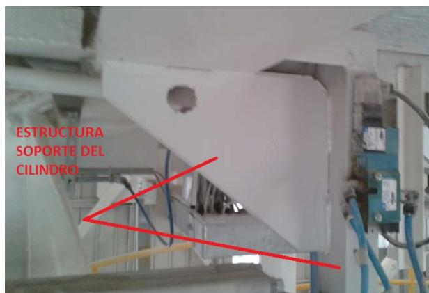
**FIGURA 5.6 - ESTRUCTURA DE SOPORTE DEL CILINDRO NEUMÁTICO**
