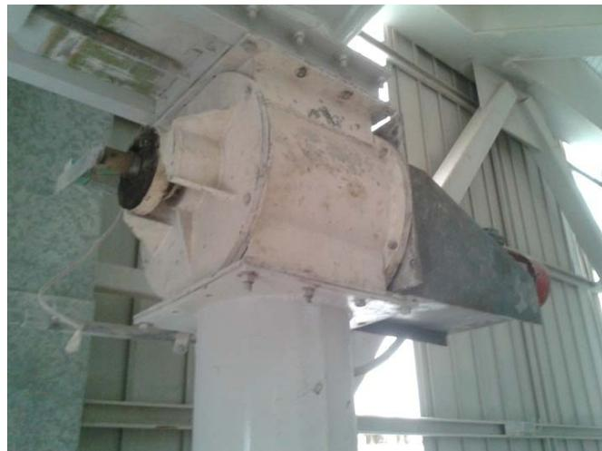
**FIGURA 5.17 - VÁLVULA ROTATIVA ACOPLADA EN EL SITIO**
