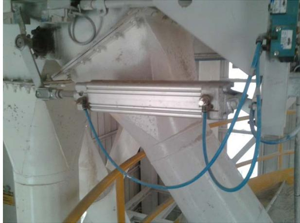
**FIGURA 5.7 - CILINDRO NEUMÁTICO DOBLE EFECTO CON ACCESORIOS**
