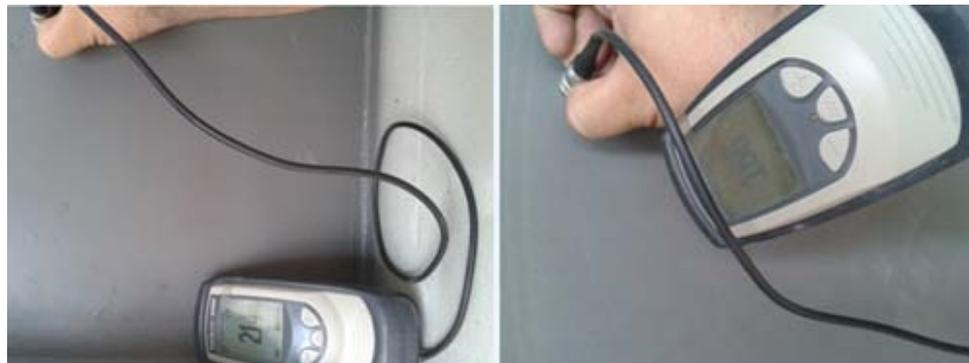
**FIGURA 4.4 - MEDICIÓN DE ESPESORES CON EL MICRÓMETRO DIGITAL**
