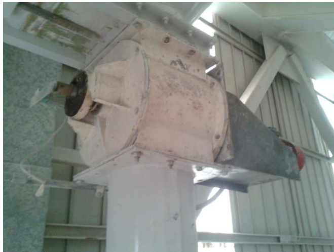
FIGURA 5.17 - VÁLVULA ROTATIVA ACOPLADA EN EL SITIO
