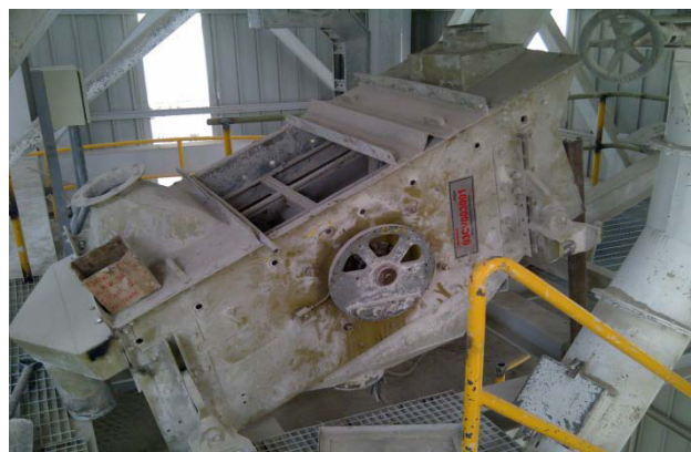
FIGURA 5.9 - EQUIPO VIBRATORIO CRIBA PRE- INSTALADA
