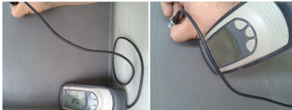
FIGURA 4.4 - MEDICIÓN DE ESPESORES CON EL MICRÓMETRO DIGITAL
