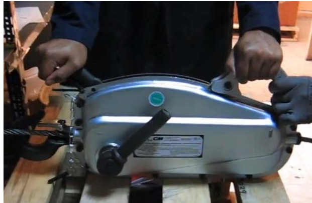
FIGURA 5.1 - TIRFOR 3 TON USADO EN EL LEVANTAMIENTO DE LOS EQUIPOS
