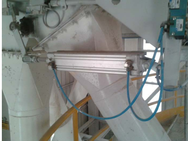
FIGURA 5.7 - CILINDRO NEUMÁTICO DOBLE EFECTO CON ACCESORIOS
