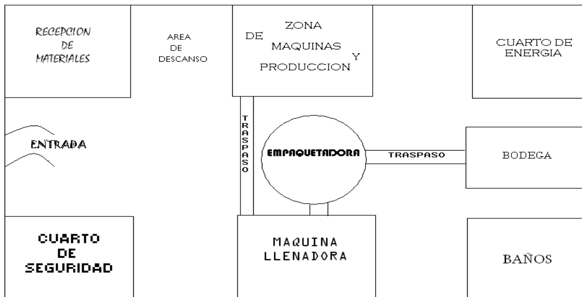
Figura 2.0.7 :Plano de la planta procesadora
