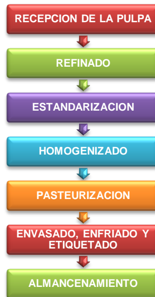
Figura 9. Proceso de producción del néctar de babaco Fuente: Elaborado por los autores
