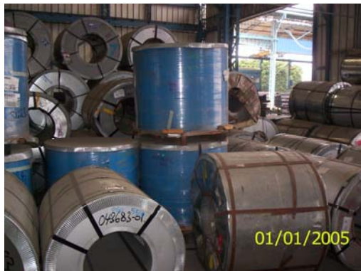
FIGURA 23. ALMACENAMIENTO DE BOBINAS: PREPINTADAS.
