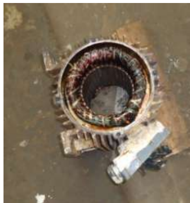
Figura 7.5 Motor desarmado para reparar devanado
