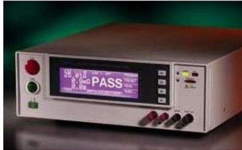
**Figura 1.14 Medidor de continuidad**
