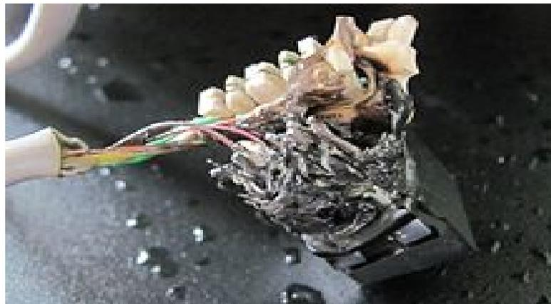
**Figura. 1.3 Efectos de un cortocircuito**
