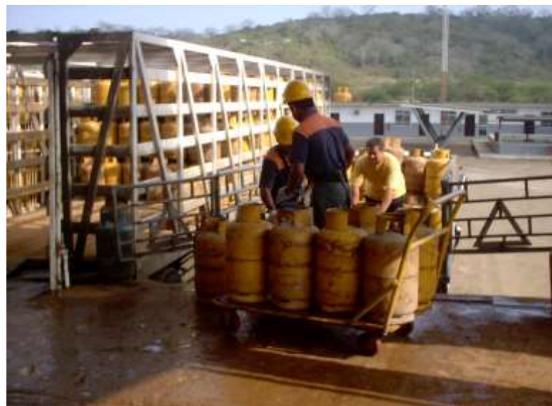
FIGURA 2.1 DESCARGA DE CILINDROS VACIOS
