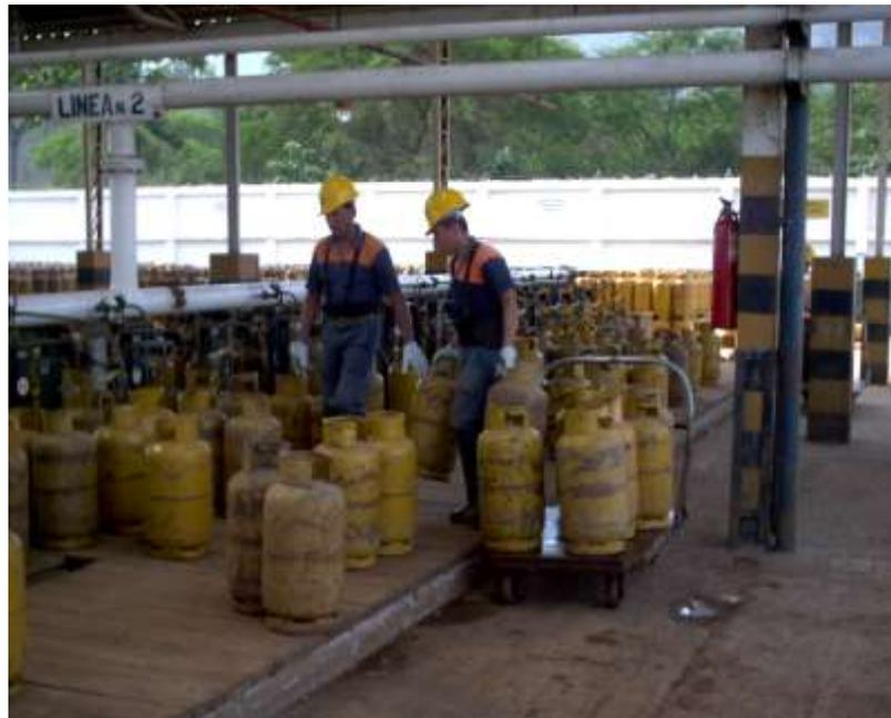
**FIGURA 2.2** TRANSPORTE DE CILINDROS VACIOS A BALANZAS
