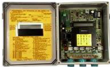
FIGURA 3.8. TOTALIZADOR ELECTRONICO DE CAUDAL
