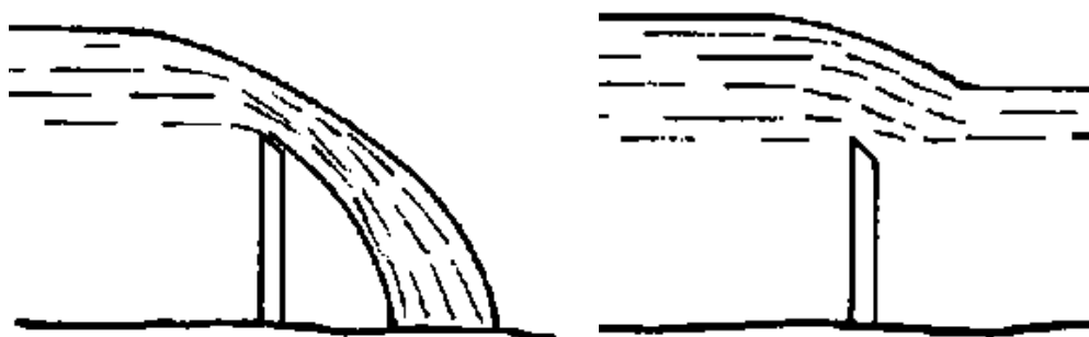
FIGURA 2.5 CORRIENTE LIBRE Y CORRIENTE SUMERGIDA SOBRE UN VERTEDERO DE PARED DELGADA
