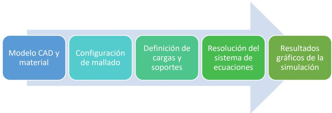
Figura 2.6 Proceso resumido de simulación estática
