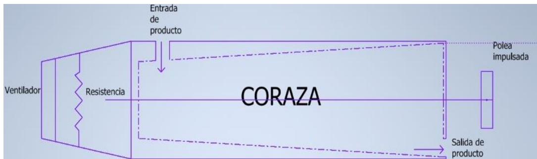
Figura 2.1 Diseño conceptual del secador rotatorio
