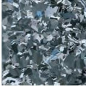
**Figura 1.4 Silicio multicristalino [Jäger, 2014, p.144].**
