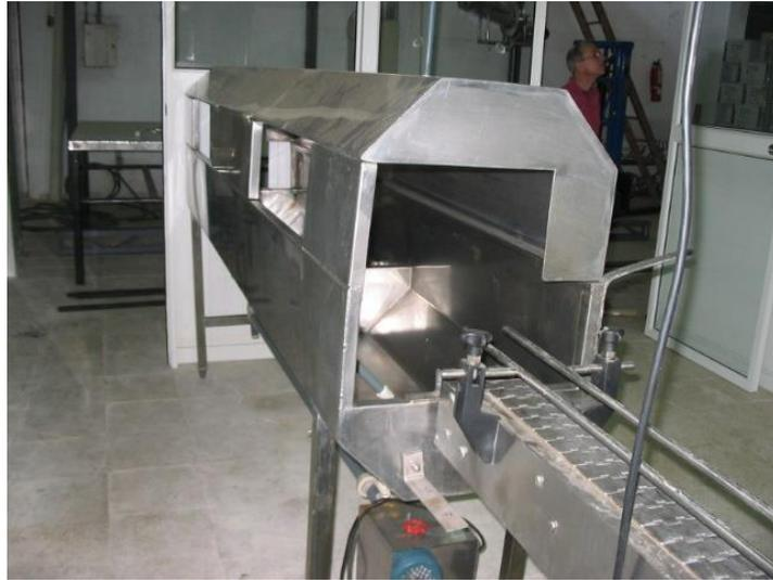
**FIG. 3.1 ENJUAGADORA LINEAL TIPO TWISTER.**
