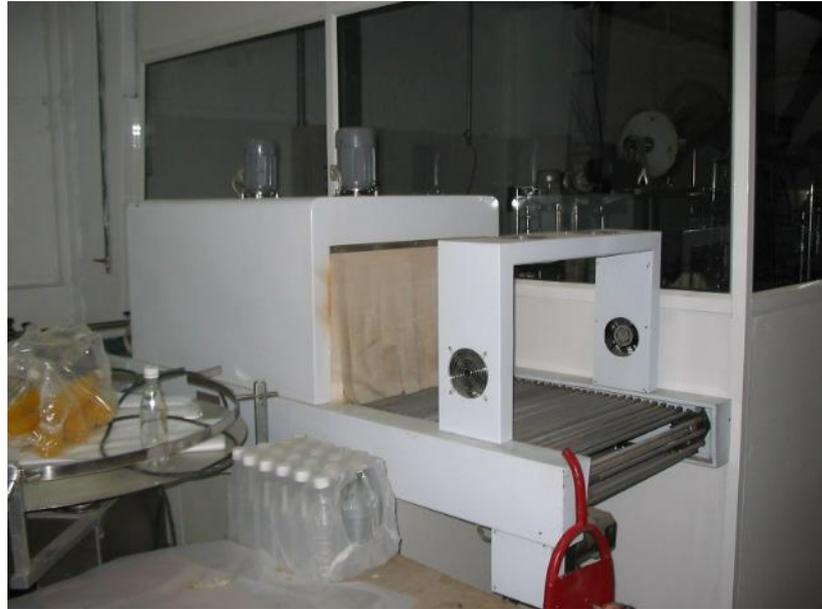
**FIG. 2.10 TUNEL DE TERMOCONTRACCION.**
