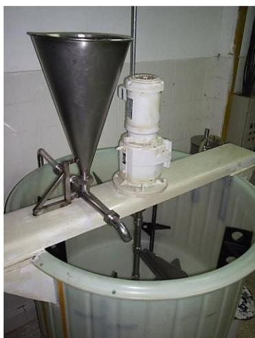
**FIG. 1.7 TANQUE DE MEZCLA.**
