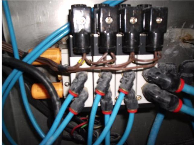
**FIG. 5.3 INSTALACIÓN DEL BLOQUE DE VÁLVULAS.**
