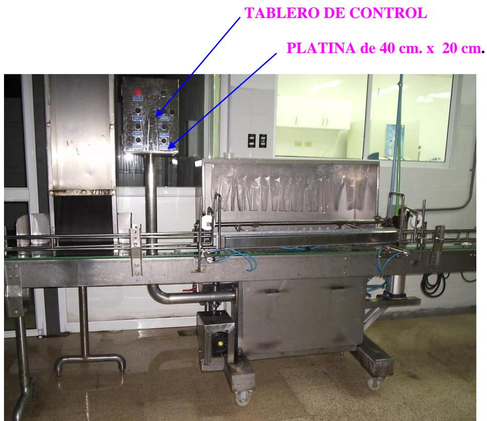
**FIG. 5.2 INSTALACIÓN DEL TABLERO ELECTRICO DE LA ENJUAGADORA DE BOTELLAS.**
