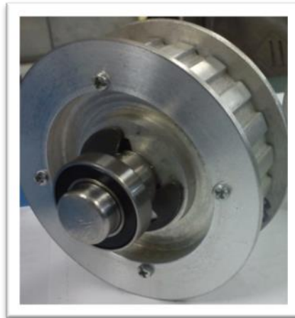
Figura 1.50. Polea conducida, con eje y rodamientos.
