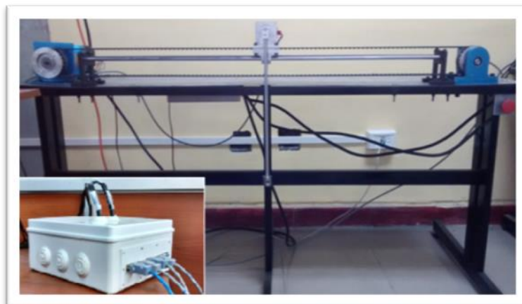
Figura 1.60. Sistema de péndulo invertido real con detalle de caja de conexiones
