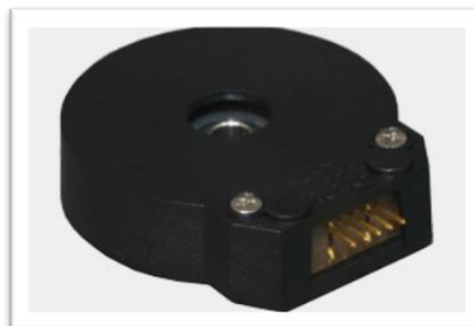
Figura 1.54. Encoder óptico incremental.
