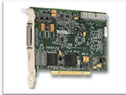
Figura 1.56. Tarjeta de adquisición de datos NI PCI-6221.
