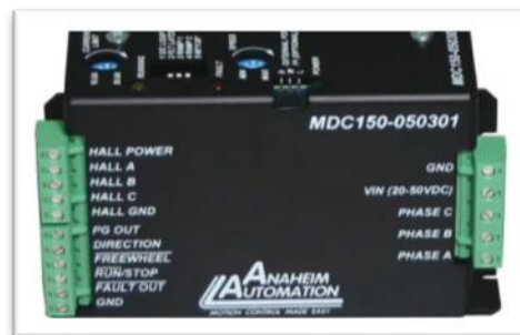
Figura 1.47. Amplificador de corriente (DRIVER o Conductor del Motor)
