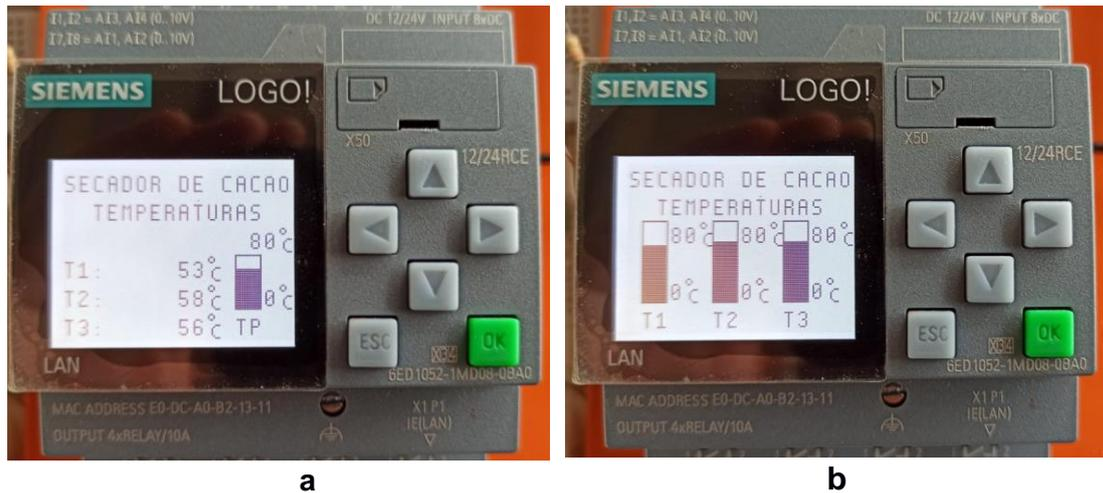
Figura 3-3: a) Se muestra el valor de las temperaturas medidas por los sensores. b) Se muestra las temperaturas en barras con un rango de 0-80 °C
