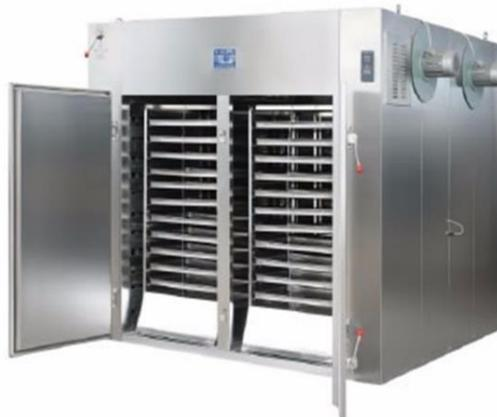
**Figura 1-1: Secador de Bandeja [6]**
