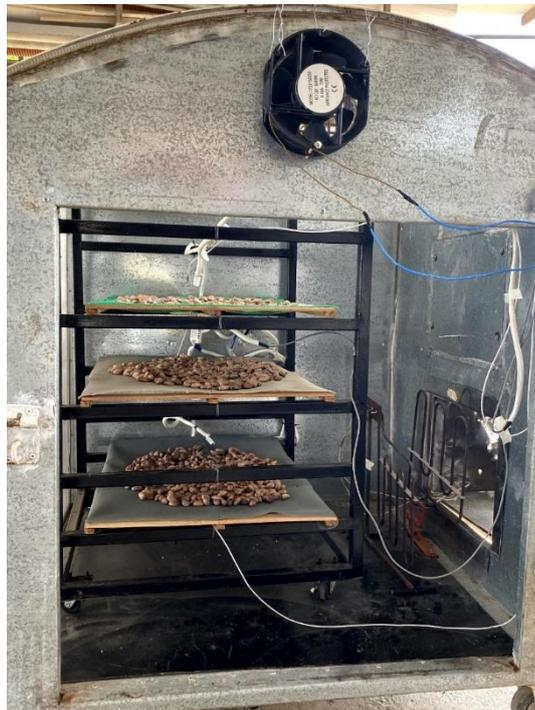
**Figura 3-21: Secador con las bandejas**
