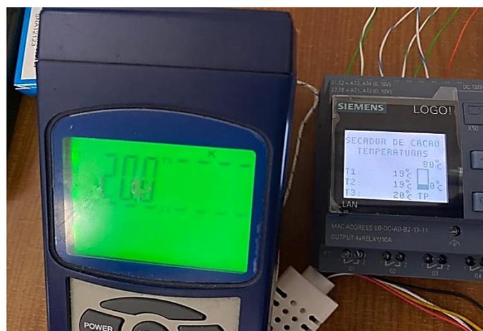
**Figura 2-48: Comparación de mediciones de temperatura entre el sistema de control y termómetro con datalogger REED SD-947.**
