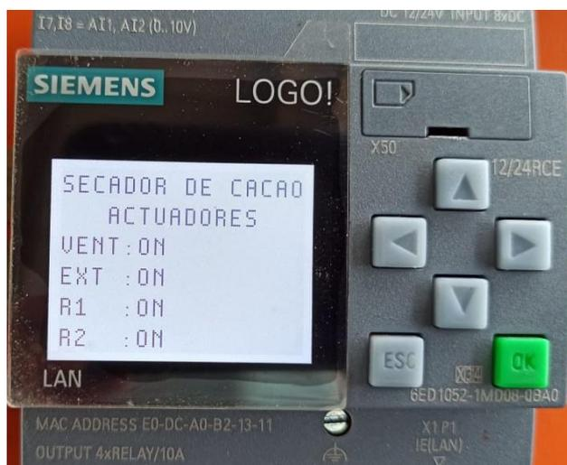
**Figura 3-6: Estado de los actuadores del sistema (ventilador, extractor, resistencia 1 y resistencia 2).**
