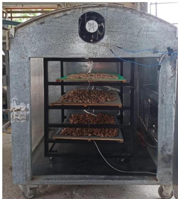
**Figura 3-9: Cámara de secado**
