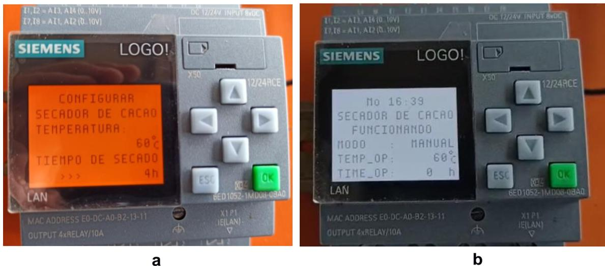
**Figura 3-2: a) Pantalla de configuración del proceso. b) Pantalla de operación del proceso.**
