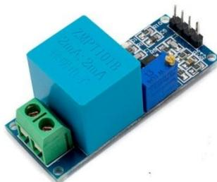
**Figura 2-11: Sensor de voltaje**
