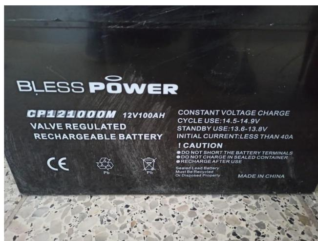
Figura 2-24: Características de la batería de la marca Bless Power.
