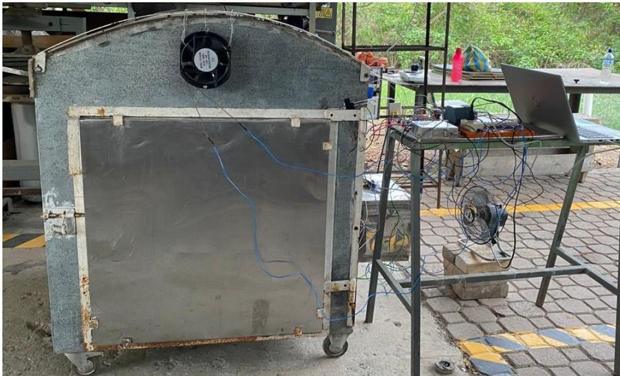
La figura 2-52 permite observar la puesta en marcha del equipo, la cual se realiza un prototipo de secador que cuenta con las siguientes dimensiones:
