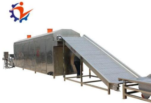
**Figura 1-2: Secador de Túnel [6]**
