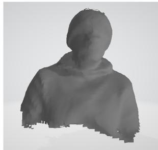
**Figura 2.4 Resultado PLY de *RGBD-Integration-2020* con 133 frames.**
