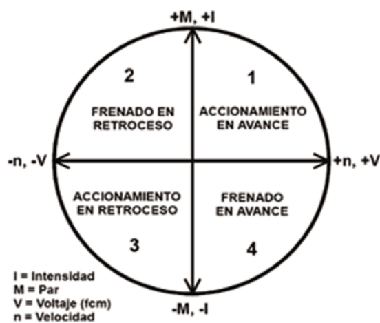
Figura 2.9: Cuadrantes de Operación de Máquina Eléctrica.
