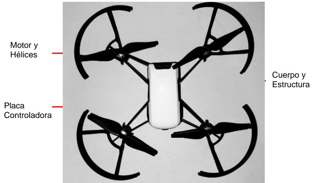
Figura 2.2. Partes de un Cuadricóptero. [18]
