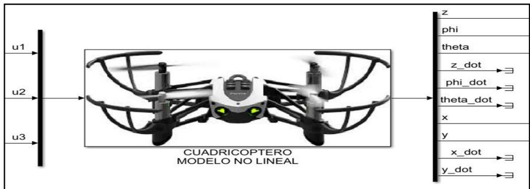
Figura 3.2. Entradas y Salidas representación del Sistema Cuadricóptero
