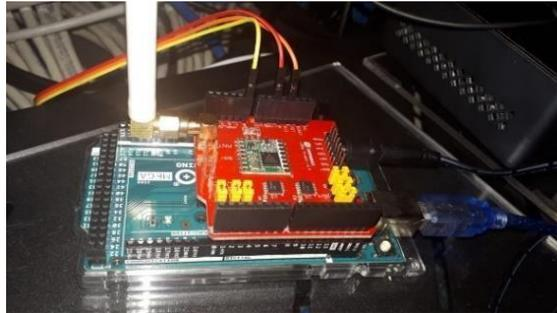
Figura 2.11 Ubicación en sitio del LoRa Shield y Arduino Mega 2560
