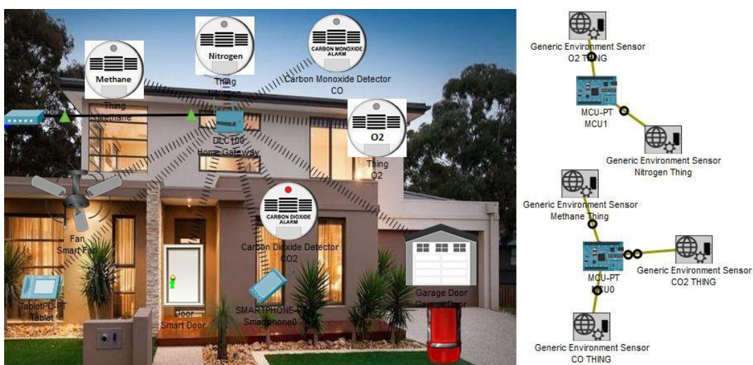
Figura 2.1 Topología tipo estrella en simulador Cisco Packet Tracer
