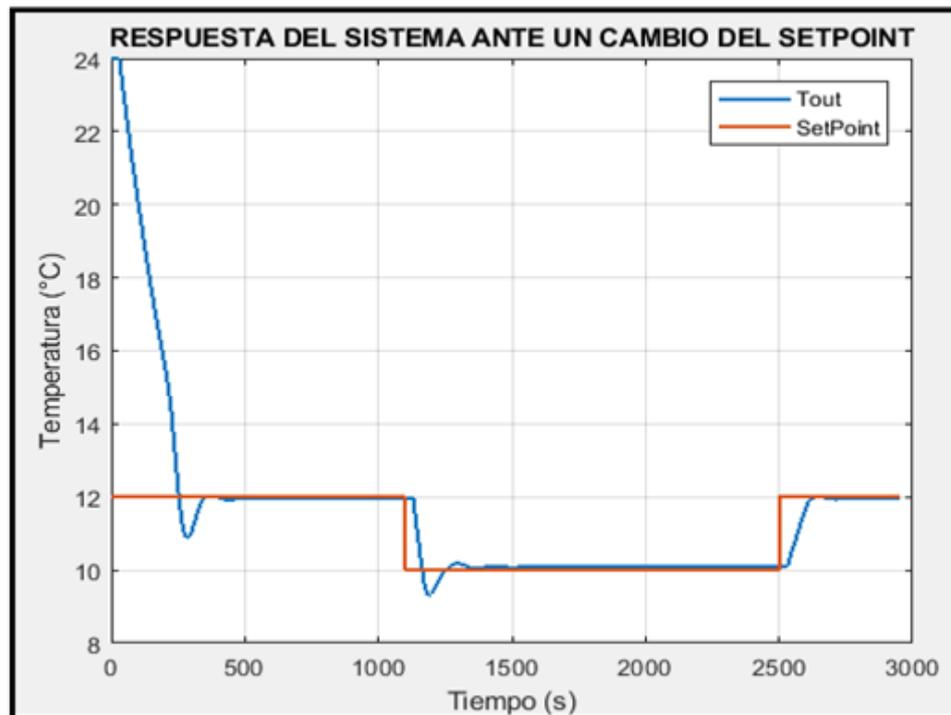
Figura 5.8 Respuesta del sistema a una variación del setpoint.
