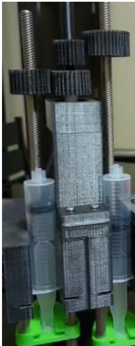
Figura 3.2 Ensamble con el eje intermedio y el soporte del eje
