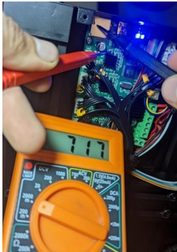
Figura 2.13 Medición voltaje de referencia del driver controlador del extrusor.
