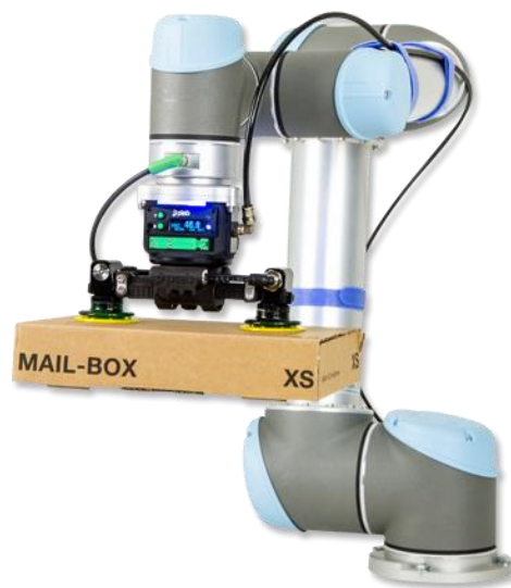
Figura 1.12 Brazo robótico con sujeción por ventosas
