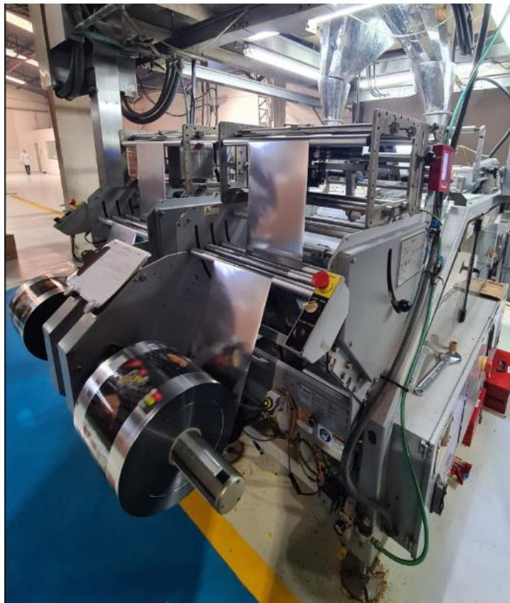
Figura 1.13 Sección de entrada de la máquina envasadora
