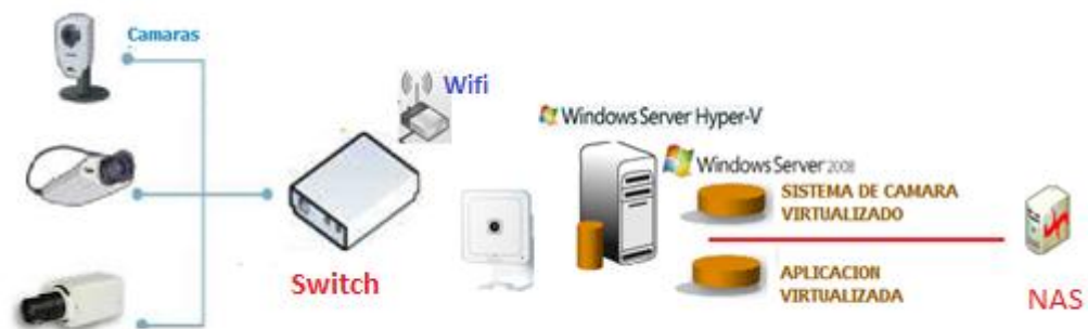
Fig. 5.17 Sistema de cámara de video
