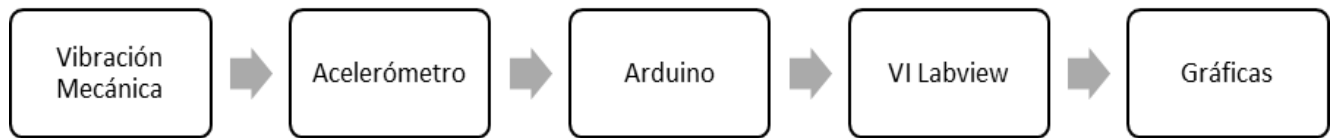
Figura 1.2 Esquema de adquisición de datos de vibraciones con Arduino.
