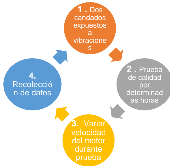
Figura 2.5 Ciclo de operación del Banco de prueba.
