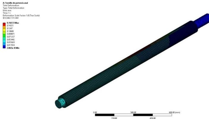
Figura 3. 2 Deformación mínima y máxima que presenta el elemento
