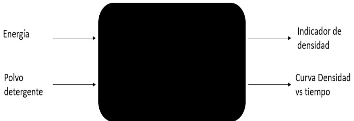
Figura 2.1 Caja negra del medidor de densidad.
