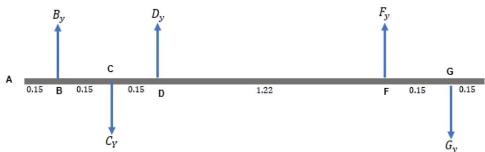
**Figura 2.24. Diagrama de fuerzas en el plano xy [Fuente: Elaboración propia].**
