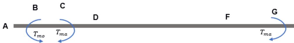
**Figura 2.22: Diagrama de momentos en el eje de rotación [Fuente: Elaboración propia].**
