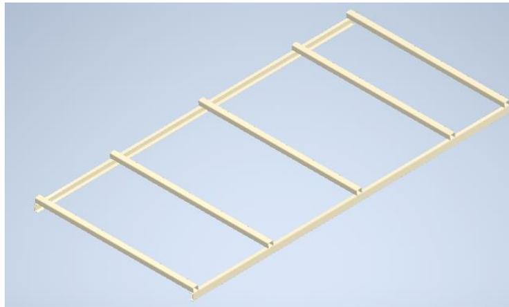
**Figura 3.6: Esqueleto de la caja de la zaranda [Fuente: Elaboración propia].**
