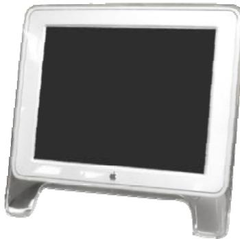
Una pantalla de cristal líquido o LCD (Liquid Crystal Display) es una pantalla delgada y plana formada por un número de píxeles en color o monocromos colocados delante de una fuente de luz o reflectora. A menudo se utiliza en dispositivos electrónicos de pilas, ya que utiliza cantidades muy pequeñas de energía eléctrica.
