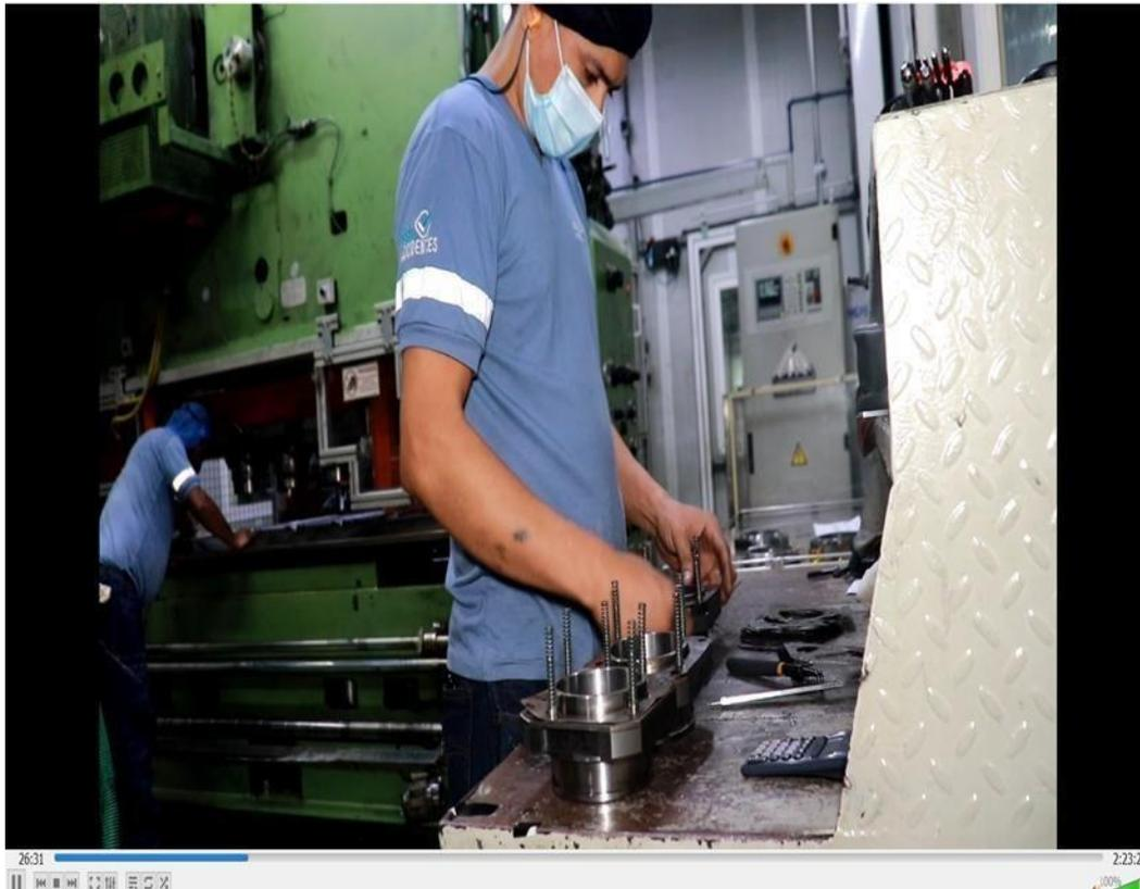
**Figura 2.15 Armado de herramientas**
