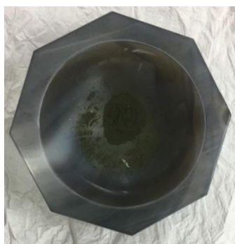
Ilustración 3.6 Nanopartículas de plata (Ag-NPs) sintetizadas en estado sólido
