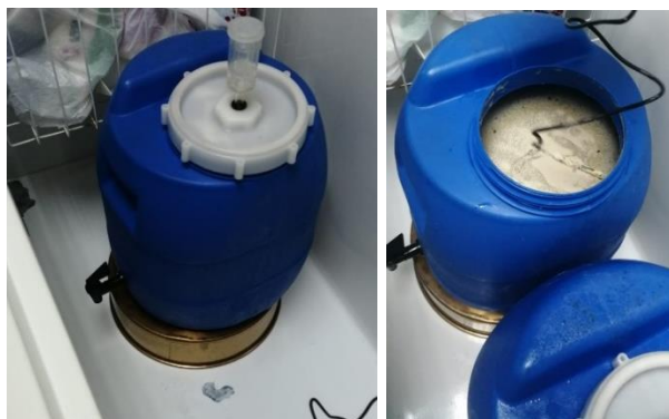
Figura 2.2 Sistema de fermentación en nevera sin termostato (izquierda) y con termostato (derecha) a temperatura variable.
