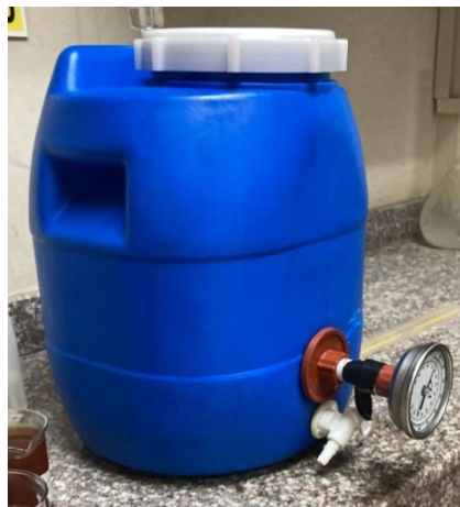
Figura 2.1 Sistema de fermentación sin termostato en cuarto acondicionado a temperatura constante.
