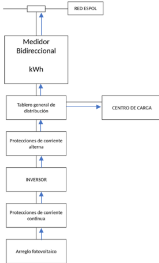
Figura 1-3 Diagrama de una interconexión eléctrica
