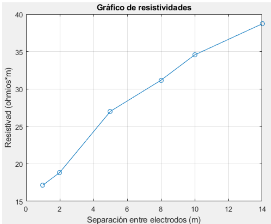
Figura 3-2. Curva de resistividad del terreno
