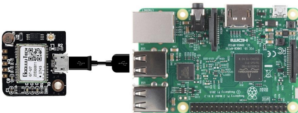
Ilustración 2.3. Conexión Módulo GPS con Raspberry Pi
