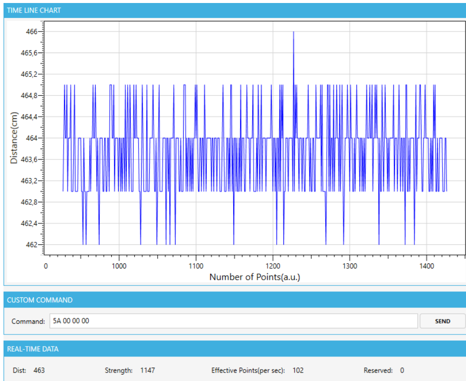
Ilustración 3.2. Adquisición de datos Lidar TF-Luna con fuerza de señal de 1100
