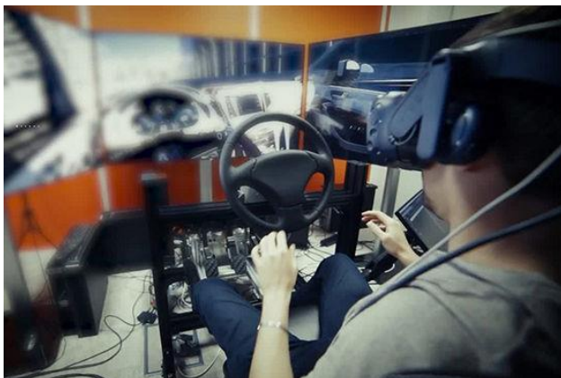
Ilustración 2.1. Ejemplo del uso de un simulador de manejo integrado con el software de Ansys para simulación vehicular AV y ADAS.
