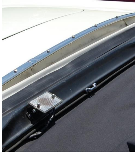
Ilustración 1.3. Ejemplo de sensor de lluvia instalado en la base del parabrisas
