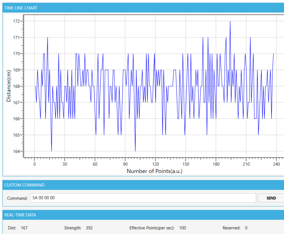
Ilustración 3.3. Adquisición de datos Lidar TF-Luna con fuerza de señal de 300
