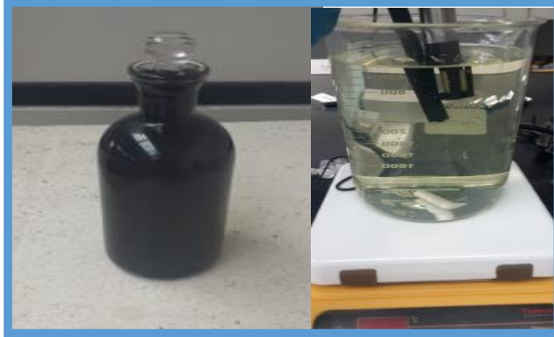
Anexo 1: Testeo del incremento de oxígeno disuelto como efecto de los compuestos comerciales H_2O_2 y Na_2H_3CO_6 .
