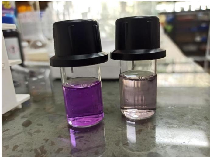
**Figura 2.5 Muestra de agua del acuario y blanco listos para colocar en el fotómetro.**
