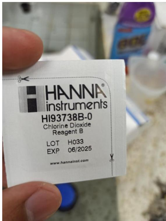
Figura 4.4 Reactivos en polvo usados para determinar la concentración de  $\text{ClO}_2$
