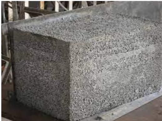
**Ilustración 4: Bloque de hormigón liviano (Obtenido de sistemamid.com)**
