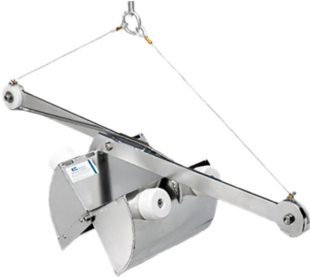
**Figura 2-8** Draga Van Veen abierta, lista para captar sedimento del fono. (OceanNet, 2022)
