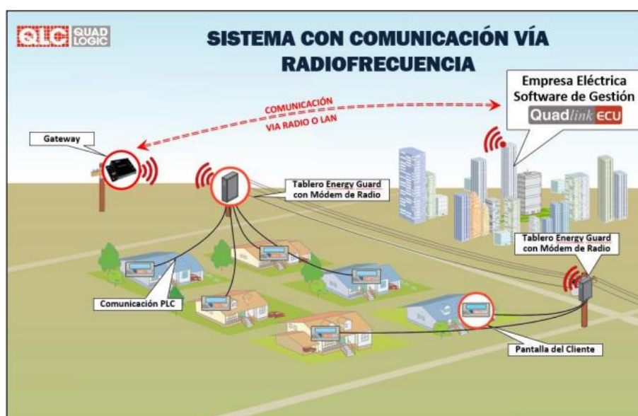
Figura 2.4 Sistema de comunicación híbrido de Telegestión Quadlogic
