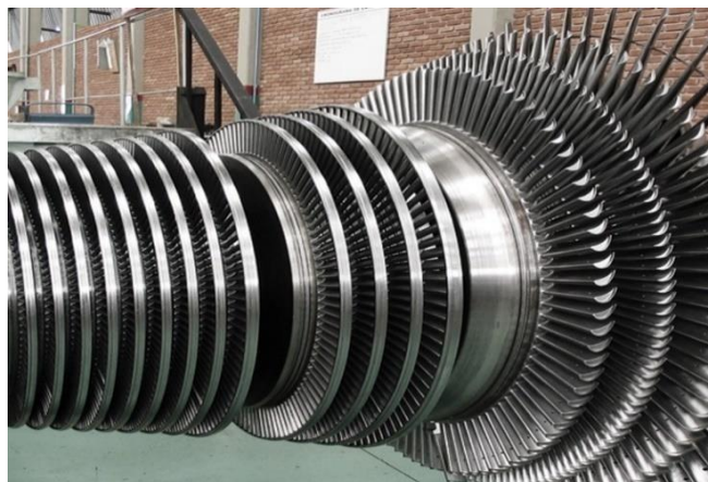
Figura 1-3: Turbina de vapor marca WEG
