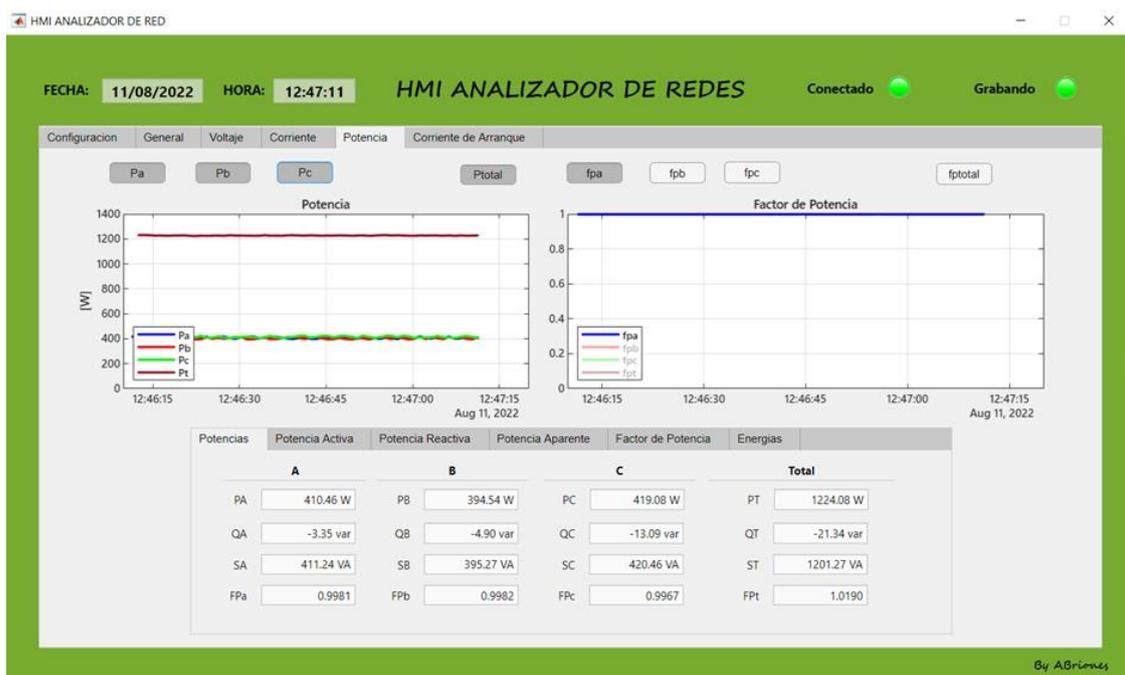
**Figura 19: Pestana de Potencia del analizador de redes.**
