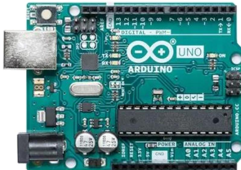
**Figura 1: Placa del Arduino Uno [4].**
