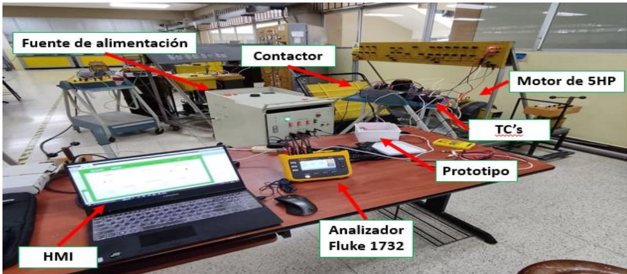
Figura 27: Equipos usados para la medición de corriente de arranque.
