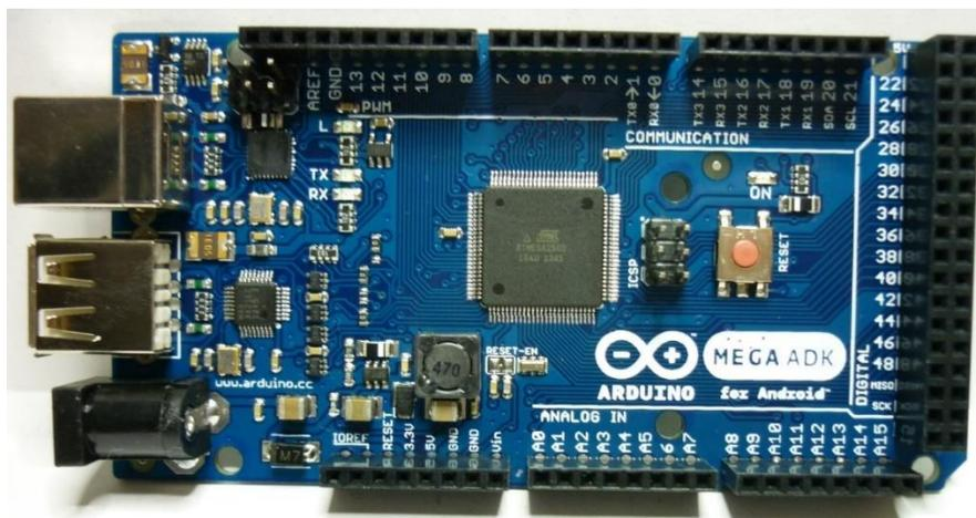
Figura 3: Placa del Arduino Mega ADK [4].
