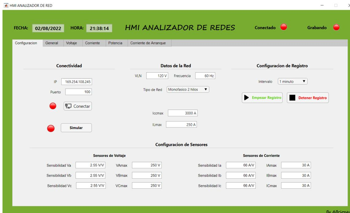
**Figura 15: Pestaña de configuración del analizador de redes.**
