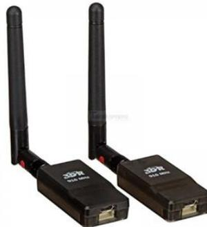
**Figura 2.4 SiK Radio de telemetría [16]**
